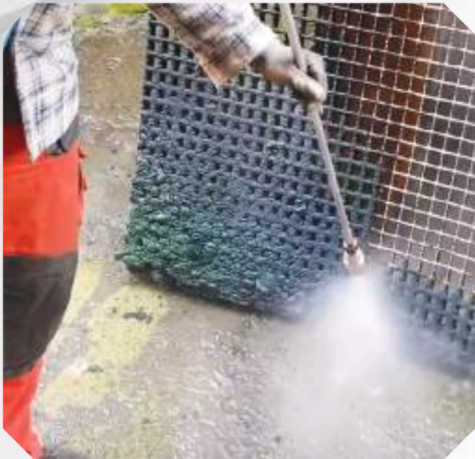
Чистка решётки окрасочной камеры
